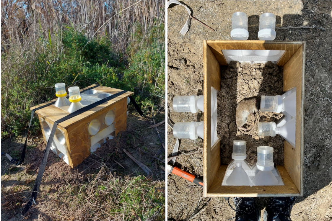
Figura 3: Trampa de invertebrados carroñeros. La trampa de invertebrados carroñeros dispone de 10 puntos de salida y de 10 entradas. Todos los puntos de salida disponen de botes de recogida de invertebrados, mientras que únicamente el 50% de las entradas están equipadas con botes de captura, permaneciendo el resto libres para permitir el acceso de los invertebrados a la carroña.
