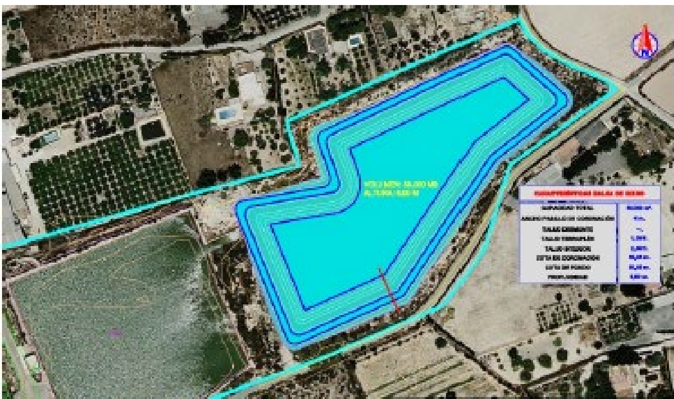
Ilustración 1: Balsa de 58.000 m 3 ubicada en la 4ª Elevación
