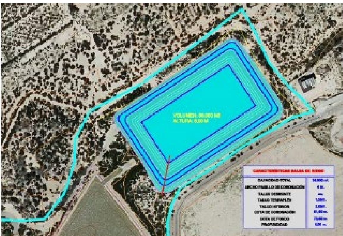
Ilustración 2: Balsa de 36.000 m 3 ubicada en la 5ª Elevación
