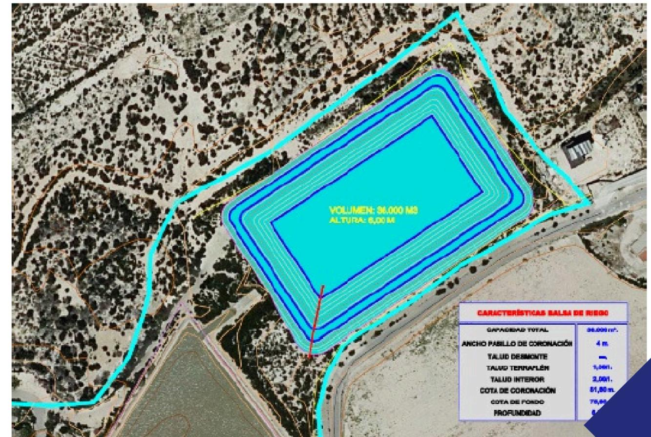
Ilustración 2: Balsa de 36.000 m<sup>3</sup> ubicada en la 5<sup>º</sup> Elevación
