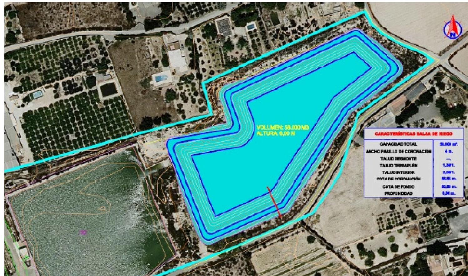
Ilustración 1: Balsa de 58.000 m<sup>3</sup> ubicada en la 4<sup>º</sup> Elevación
